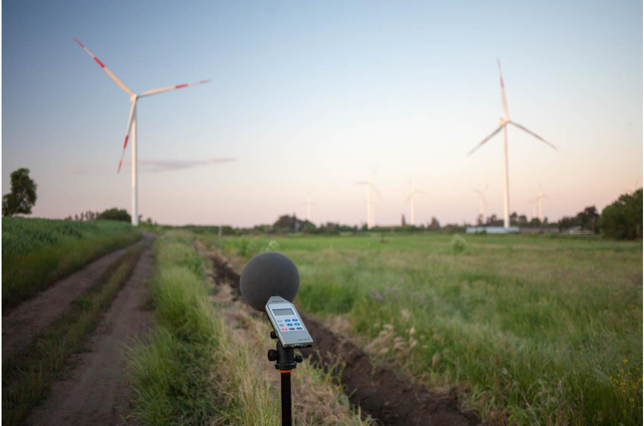
Figura 14. Medición discreta en parque eólico utilizando pantalla antiviento ACO PACIFIC WS7-80T.
