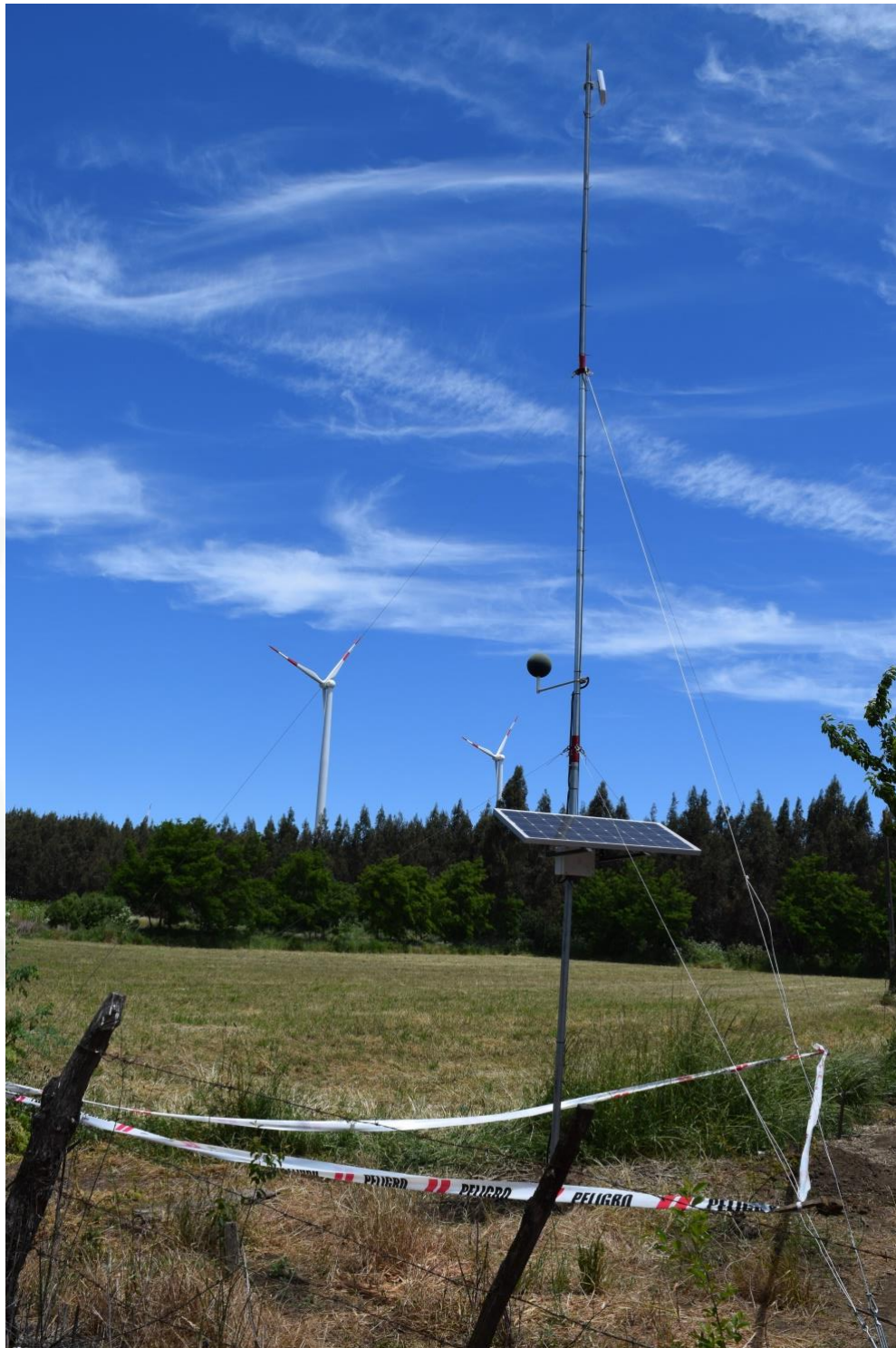
Figura 12. Medición continua de ruido en parque eólico utilizando sonómetro Absentia Capta.
