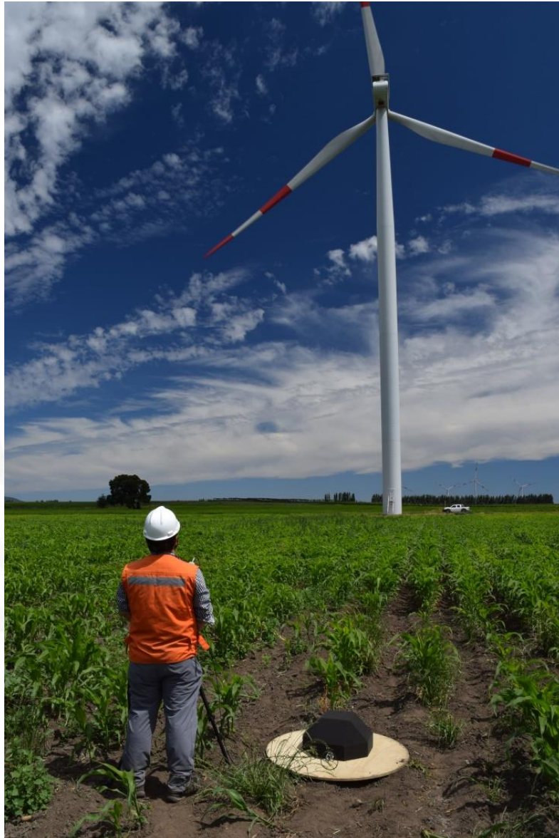
Figura 16. Medición de ruido de aerogenerador utilizando pantalla antiviento ACO PACIFIC HEMI18.
