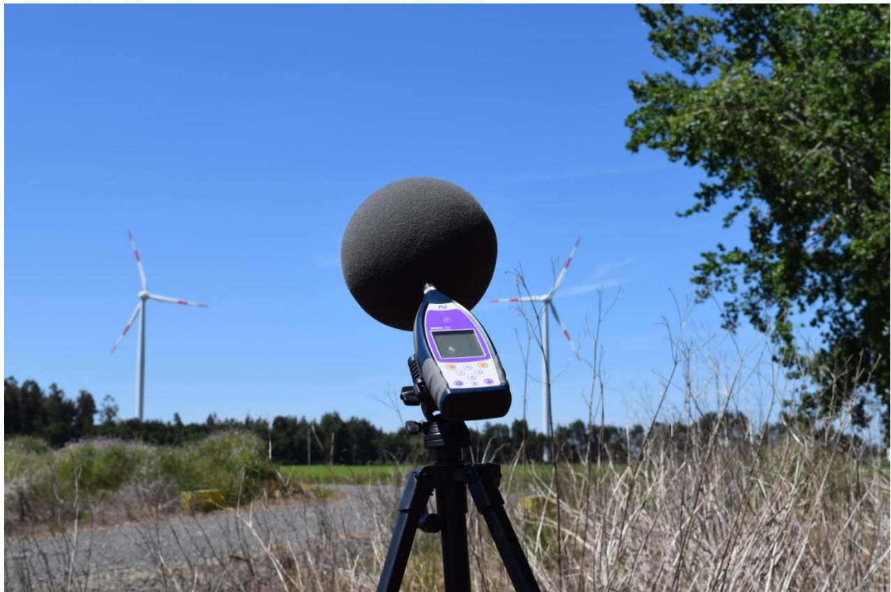
Figura 13. Medición discreta en parque eólico utilizando sonómetro BSWA 309.
