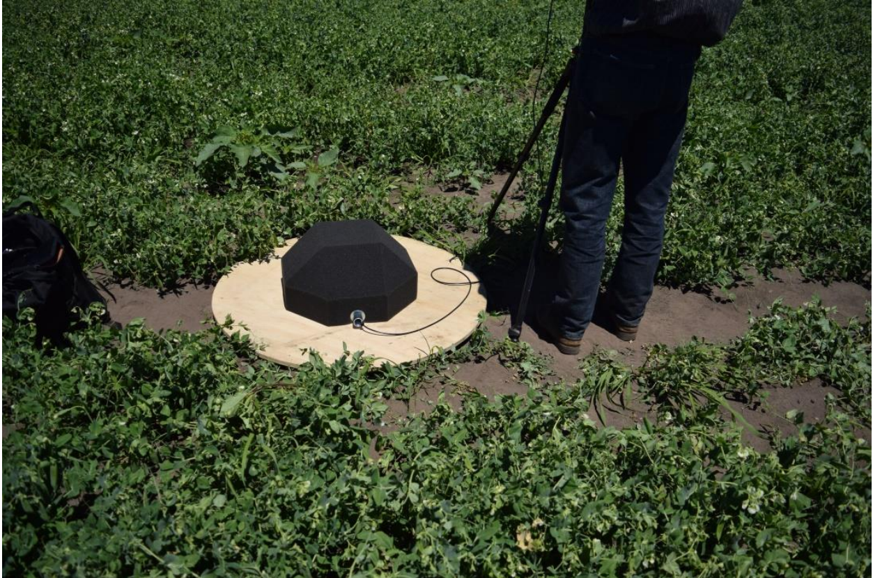
Figura 17. Medición de ruido de aerogenerador utilizando placa reflectante.
