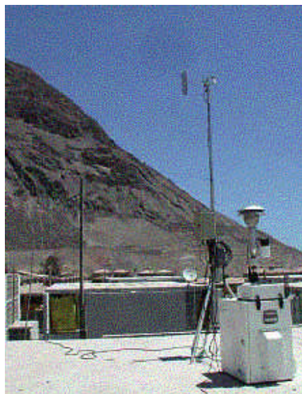
Figura 34. Emplazamiento de Equipos HI MP 10 en la Ciudad de Iquique . Proyecto Monitoreo CONAMA I Región. Febrero 2008 a Enero 2009.
