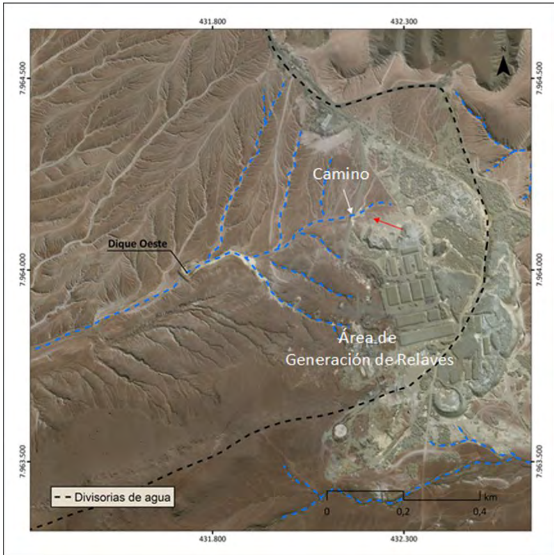
Figura 23. Quebradillas hacia quebrada Cardones. Todas las que tienen contacto con residuos, drenan hacia el dique oeste. El camino indicado actúa como pretil de contención de posibles arrastres hacia el dique oeste (flecha indica pendiente)
