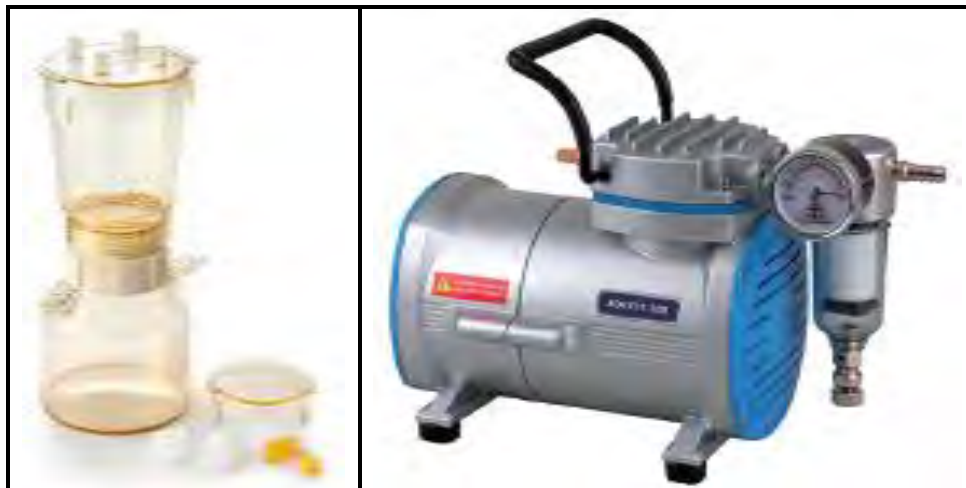
Fotografía N° 4: Ejemplos de equipos utilizados en filtración en terreno
