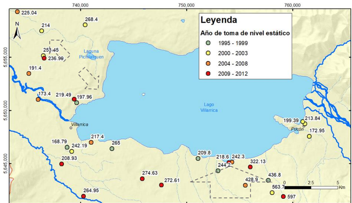
Figura 11. Mapa de pozos con su nivel piezométrico respectivo. Las flechas indican la dirección general de flujo subterráneo en la zona. Tomado de Valenzuela (2019), donde fue elaborado con datos de DGA (2016).
