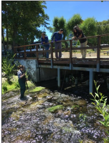
Aforo en canal colector calle O'Higgins
