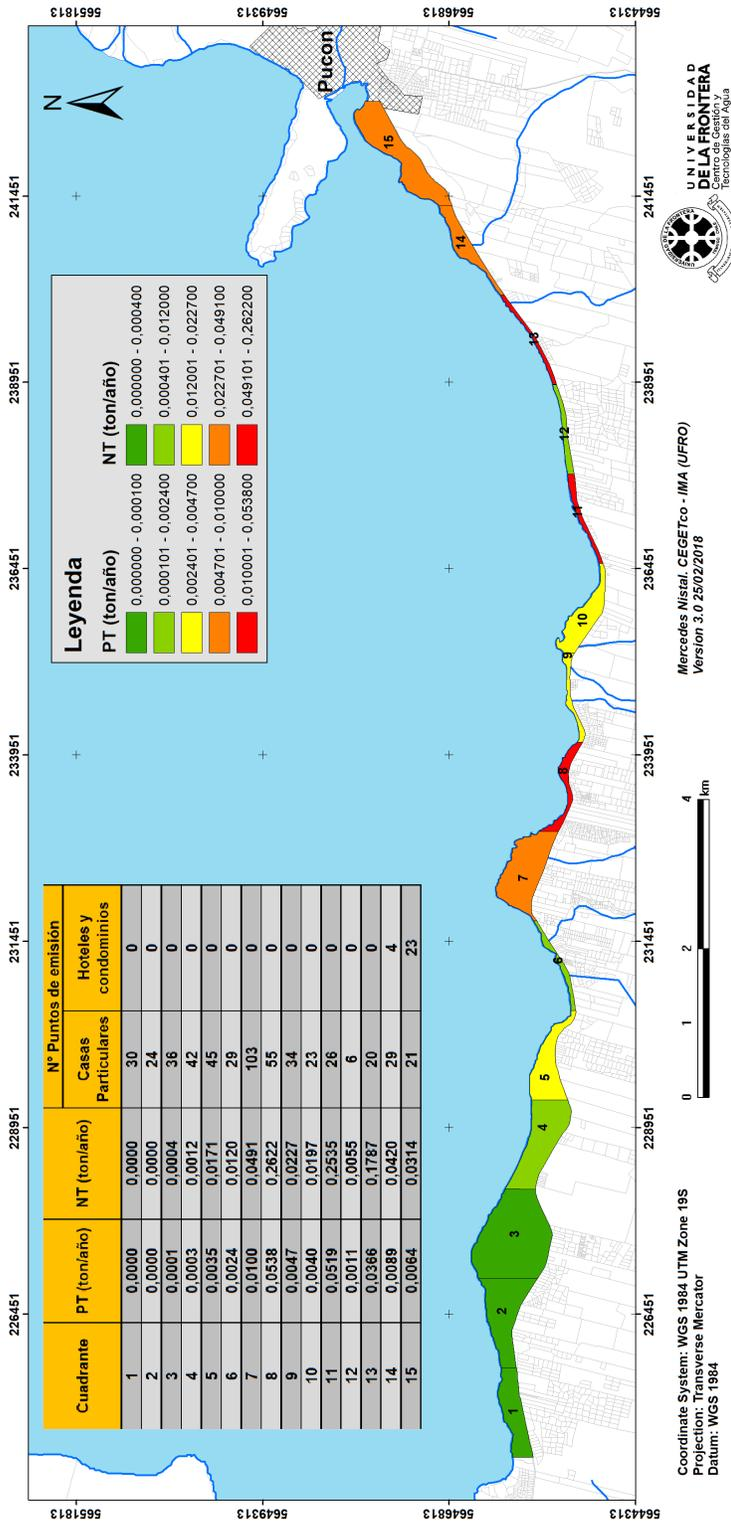
Figura 44. Zonificación del borde del lago entre las comunas de Villarrica y Pucón. Concentración de Nitrógeno y Fósforo Total por segmento. Proyección a 1 año
