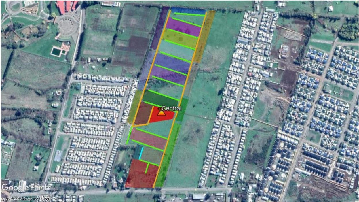
**Ilustración 106. Diseño de red propuesto para sistema de calefacción distrital en el conjunto habitacional de Labranza**
