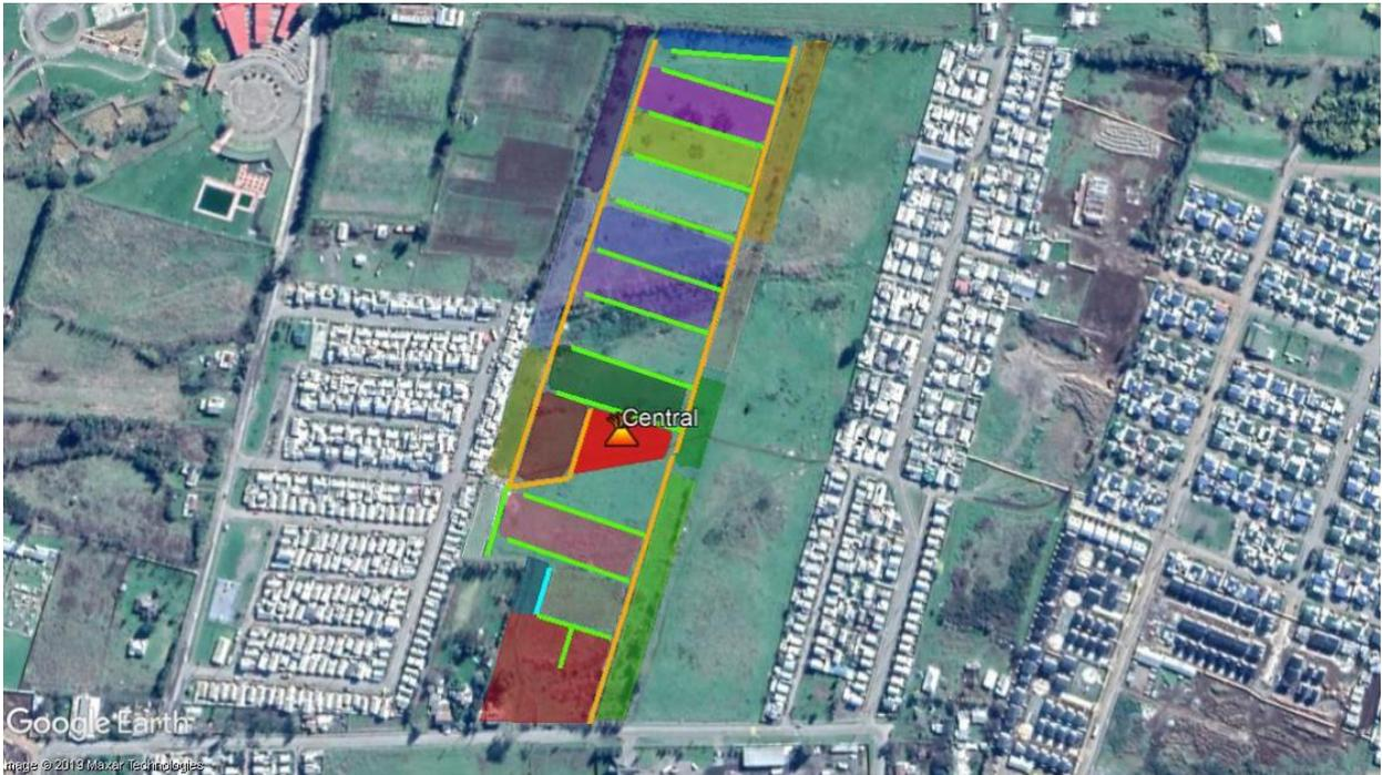
**Ilustración 79. Diseño de red propuesto para sistema de calefacción distrital en el conjunto habitacional de Labranza**
