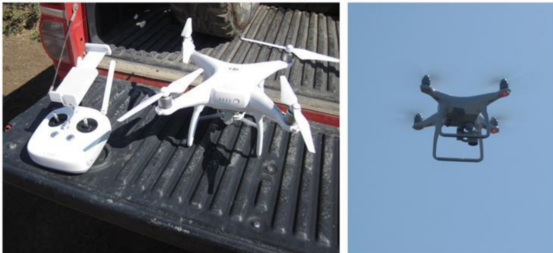
Figura 4-3 Dron modelo DJI Phantom4 utilizado para sobrevuelo y captura de imágenes del humedal costero Estuario Huasco.
