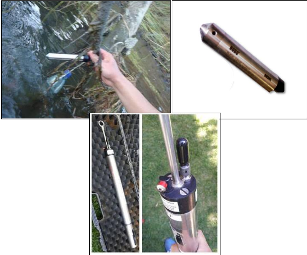
Figura 5-2. Sensor de presión y salinidad instalado en el estuario (arriba). Sonda CTD (abajo). Imagen satelital, Google Earth, 2016.
