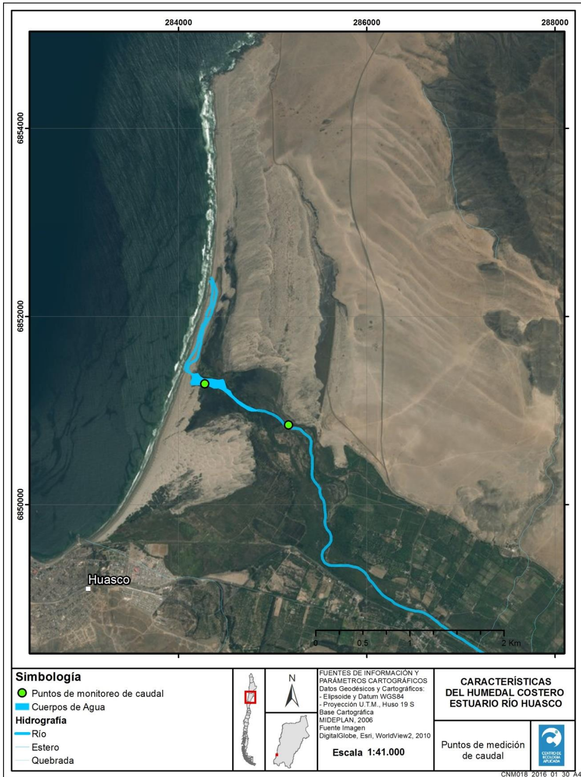
Figura 9-5 Puntos sugeridos para el establecimiento de equipamiento para el monitoreo de caudal superficial
