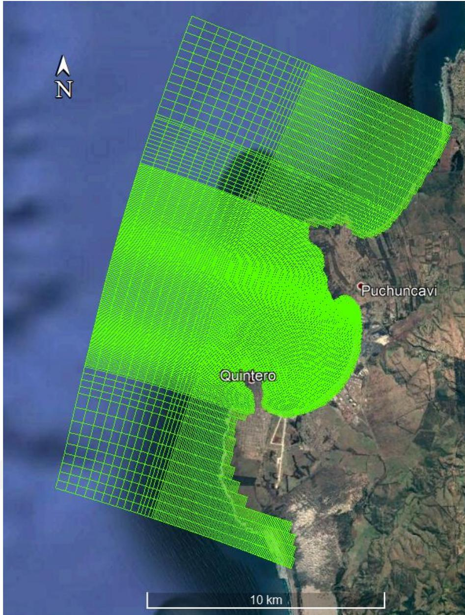
**Figura 6-2: Grilla de modelación modelo hidrodinámico y de dispersión de contaminantes.**
