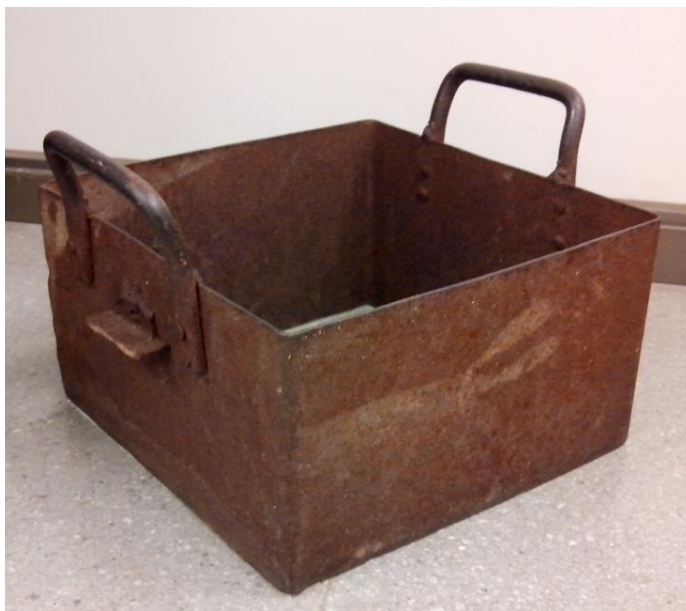
Figura 14. Muestreador Core de fierro galvanizado de 625 cm 2 con marca a los 10 cm de profundidad.
