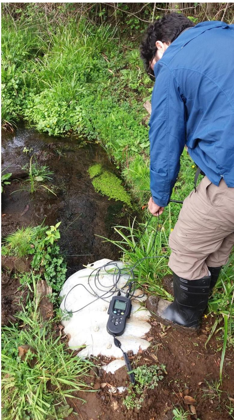
**Figura 36: Medición de parámetros fisicoquímicos mediante equipo multiparámetro, sector Lepún.**
