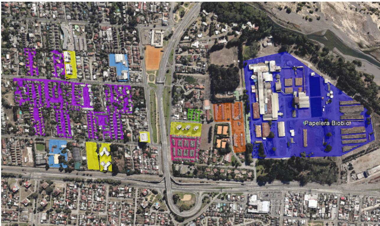
**Figura 25.** Plano de la ubicación de la Planta industrial y las viviendas evaluadas para el aprovechamiento de calor residual de la industria para sistemas de calefacción
