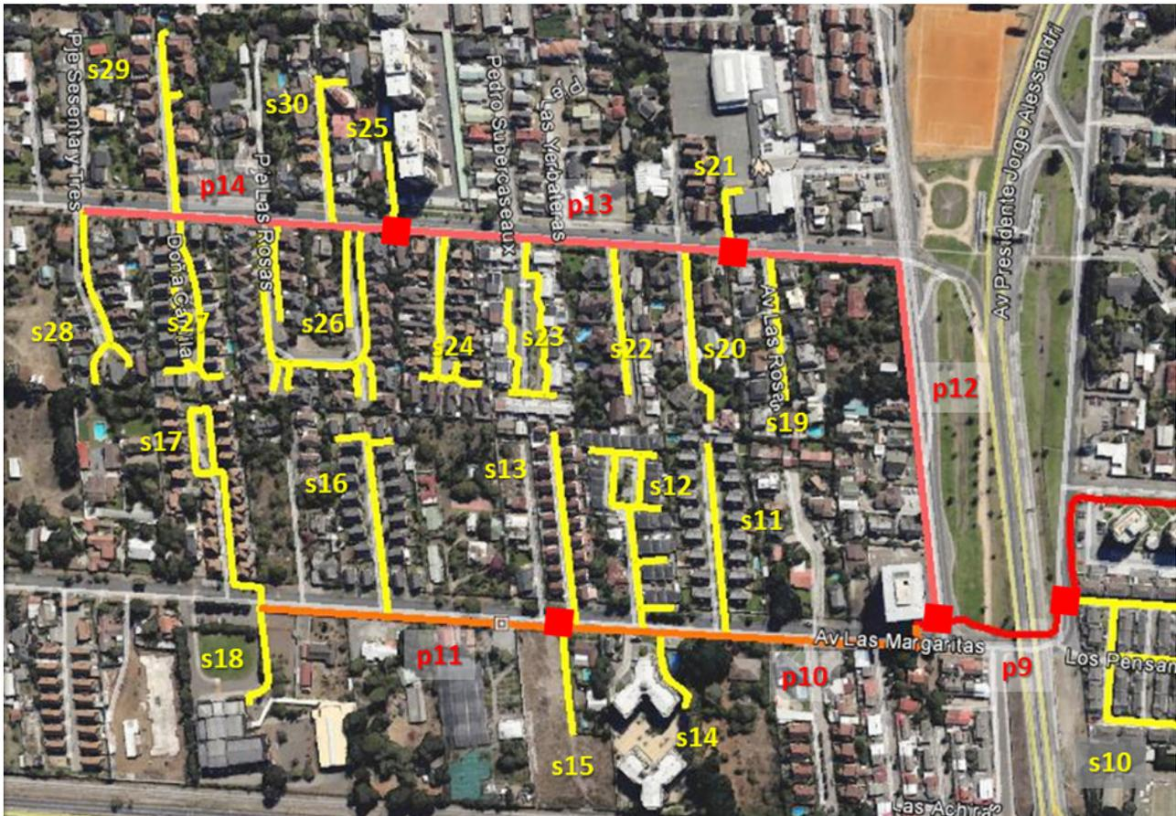
Figura 22: Diseño de red de distribución de agua caliente
