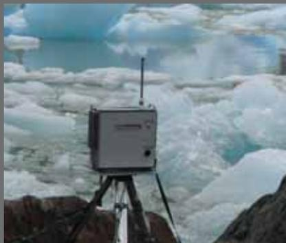
Medición en tiempo real de concentración y distribución por tamaños de material particulado en suspensión
