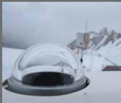
Medición de radiación solar incidente y reflejada (Albedo)
