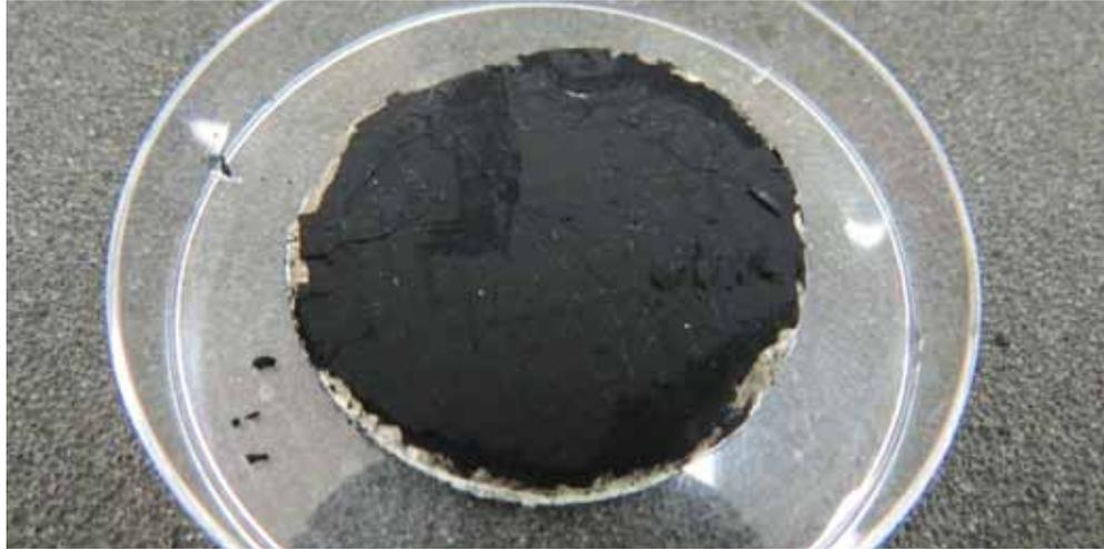
Arriba: fotografía de un filtro de material particulado recolectado desde el tubo de escape de un vehículo diésel, conteniendo principalmente BC
