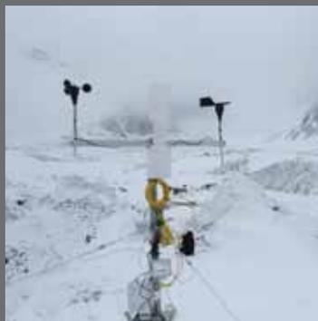
Medición de T°, %HR, P°, dirección y velocidad de viento
